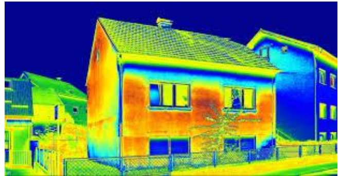
Warmtebeeldfoto geeft inzicht in warmtelekken. Bron: gemeente Nissewaard (2019).
